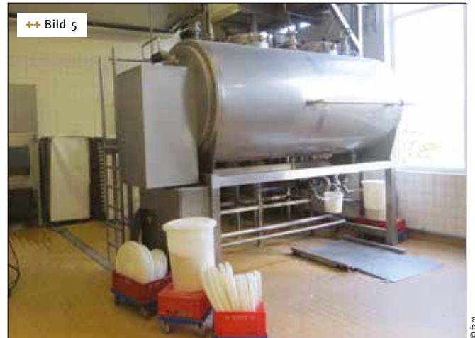
++ Bild 5 Eigenentwicklung aus dem Hause Köhler: eine Anlage, die Fermentationsanlage, in der sich die Teige ruhend entwickeln können
