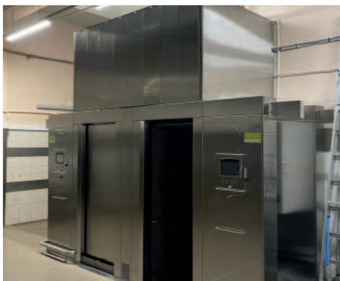
Sonderbau: 2 Schiebetür-Vakuumkonditionieranlagen mit der kompletten Technik auf der Kammer
